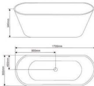
Vasca Freestanding in puro acrilico colore bianco lucido. Completa di troppo pieno, pialetta di scarico click clack, sifone e tubo di scarico e 32 mm. Supportata da struttura in acciaio inox con piedi regolabili "da cm. 0 a cm. 4 h". La vasca è realizzata in due gusci saldati, i quali conferiscono alla stessa un aspetto monolitico come se fosse un unico pezzo sia al tatto che alla vista.
