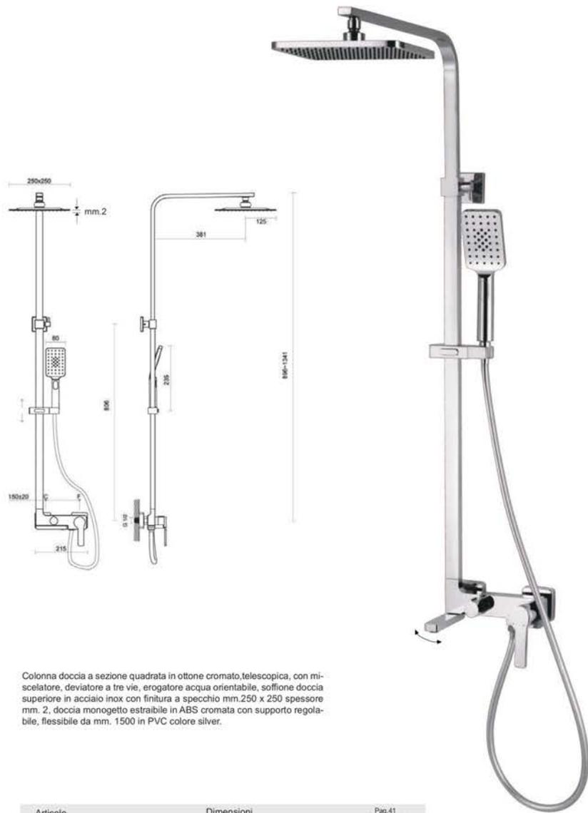
Colonna doccia a sezione quadrata in ottone cromato, telescopica, con miscelatore, deviatore a tre vie, erogatore acqua orientabile, soffione doccia superiore in acciaio inox con finitura a specchio mm.250 x 250 spessore mm. 2, doccia monogetto estraibile in ABS cromata con supporto regolabile, flessibile da mm. 1500 in PVC colore silver.
