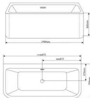
Vasca Freestanding in puro acrilico colore bianco lucido. Completa di troppo pieno, pialetta di scarico click clack, sifone e tubo di scarico ø 32 mm. Supportata da struttura in acciaio inox con piedi regolabili "da cm. 0 a cm. 4 h". La vasca è realizzata in due gusci saldati, i quali conferiscono alla stessa un aspetto monolitico come se fosse un unico pezzo sia al tatto che alla vista. Adatta per installazione DX/SX e centro parete
