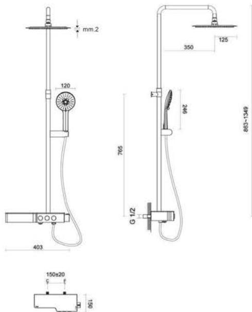
Colonna doccia a sezione tonda in ottone cromato con frontalino bianco, telescopica, deviatore a tre vie con comando a pulsanti, miscelatore, erogatore acqua, mensola, soffione doccia superiore in acciaio inox diametro mm.250 spessore mm. 2, doccia estraibile in ABS cromata con supporto regolabile, flessibile da mm. 1500 in PVC colore silver
