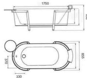
Vasca Freestanding in puro acrilico colore bianco lucido con troppo pieno. Dotata di una struttura esterna di sostegno in acciaio inox satinato. Completa di piletta di scarico click clack, sifone e tubo di scarico ø 32 mm. La vasca è realizzata in due gusci saldati, i quali conferiscono alla stessa un aspetto monolitico come se fosse un unico pezzo sia al tatto che alla vista. Questa realizzazione di Nilo Gioacchini, è stata premiata con il "Reddot Award Design Concept 2016".
