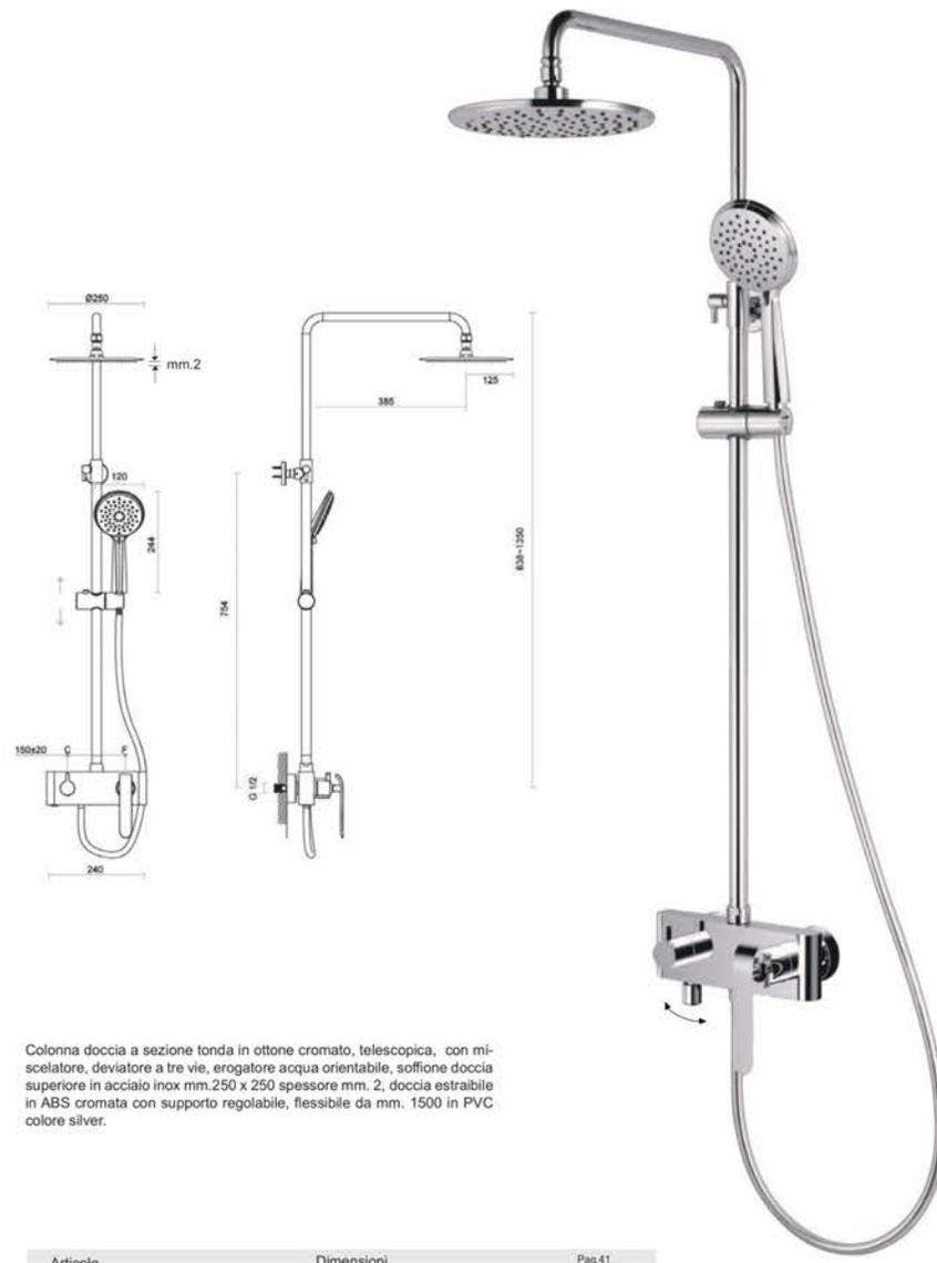
Colonna doccia a sezione tonda in ottone cromato, telescopica, con miscelatore, deviatore a tre vie, erogatore acqua orientabile, soffione doccia superiore in acciaio inox mm.250 x 250 spessore mm. 2, doccia estraibile in ABS cromata con supporto regolabile, flessibile da mm. 1500 in PVC colore silver.
