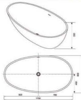
Vasca Freestanding in puro acrilico colore bianco lucido. Completa di troppo pieno, piletta di scarico click clack, sifone e tubo di scarico ø 32 mm. Supportata da struttura in acciaio inox con piedi regolabili "da cm. 0 a cm. 4 h". La vasca è realizzata in due gusci saldati, i quali conferiscono alla stessa un aspetto monolitico come se fosse un unico pezzo sia al tatto che alla vista.
