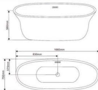
Vasca Freestanding in puro acrilico colore bianco lucido. Completa di troppo pieno, piletta di scarico click clack, sifone e tubo di scarico ø 32 mm. Supportata da struttura in acciaio inox con piedi regolabili "da cm. 0 a cm. 4 h". La vasca è realizzata in due gusci saldati, i quali conferiscono alla stessa un aspetto monolitico come se fosse un unico pezzo sia al tatto che alla vista.
