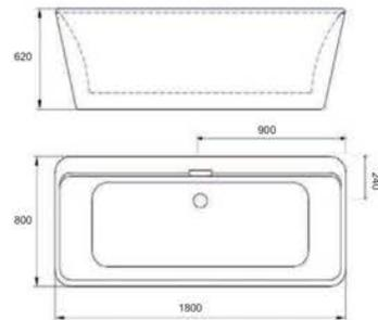
Vasca Freestanding in puro acrilico colore bianco lucido. Completa di troppo pieno, piletta di scarico click clack, sifone e tubo di scarico ø 32 mm. Supportata da struttura in acciaio inox con piedi regolabili "da cm. 0 a cm. 4 h". La vasca è realizzata in due gusci saldati, i quali conferiscono alla stessa un aspetto monolitico come se fosse un unico pezzo sia al tatto che alla vista.
