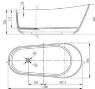
Vasca Freestanding monolite in **solid surface colore bianco matt**. Completa di troppo pieno, piletta di scarico click clack, sifone e tubo di scarico  $\varnothing$  32 mm.
