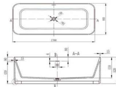
Vasca Freestanding monolite in solid surface colore bianco matt. Completa di troppo pieno, piletta di scarico click clack, sifone e tubo di scarico  $\varnothing$  32 mm.
